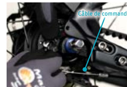
Concernant 3. Démontez le câble de commande de la roue arrière
