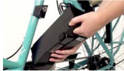
Punto 1 Sostener frente a la estación de acoplamiento
