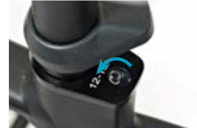
Punto 1 Aflojar el/los tornillo(s) del sillín
