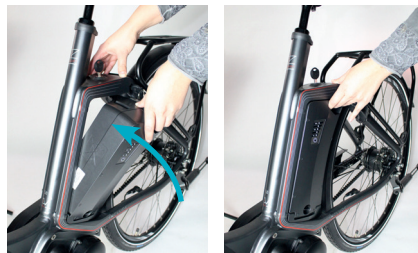
dot. pkt 3. Akumulator wsunąć do stacji dokującej
