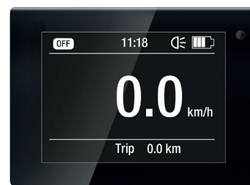
Wyświetlacz Impulse Evo Smart Compact: Menu startowe
