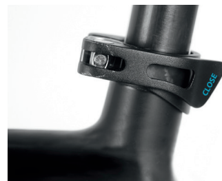
dot. pkt 2. Zamknięta dźwignia zacisku szybko mocującego
