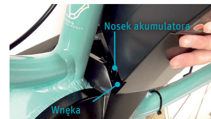
dot. pkt 2. Nosek akumulatora we wnęcie
