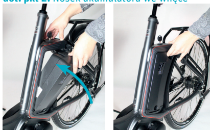
dot. pkt 3. Akumulator wsunąć do stacji dokującej
