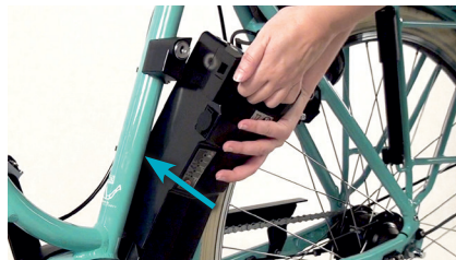
dot. pkt 3. Akumulator wsunąć do stacji dokującej
