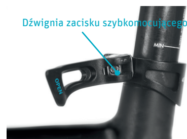
dot. pkt 1. Otworzyć dźwignię zacisku szybko mocującego.
