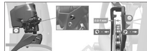
Fig. 96 Réglage de la butée supérieure ©Sram
