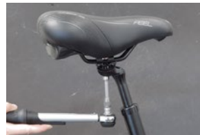
Punto 1 Aflojar el tornillo de fijación
