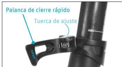
Punto 1 Abrir la palanca de cierre rápido
