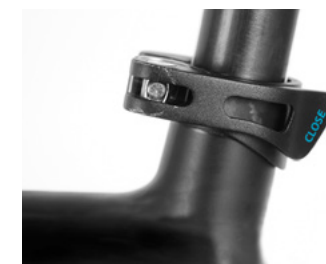
Punto 2 Palanca de cierre rápido cerrada
