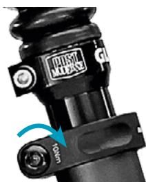
Punto 3 Apretar el/los tornillo(s) de la abrazadera del sillín
