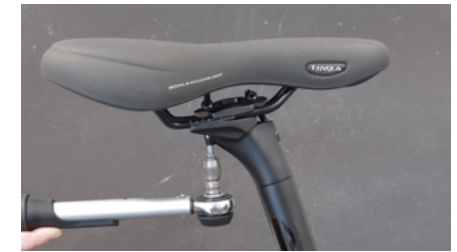
Punto 1 Aflojar los tornillos
